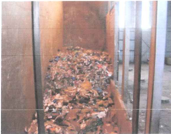
Fosse de réception des Ordures Ménagères
