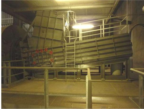
Le four de forme cylindro-conique est garni de béton réfractaire. Son mouvement oscillant à vitesse variable assure un retournement et un brassage continu des déchets. La combustion des déchets est réalisée grâce à l'injection d'air primaire au travers de buses positionnées dans le béton réfractaire du four.
