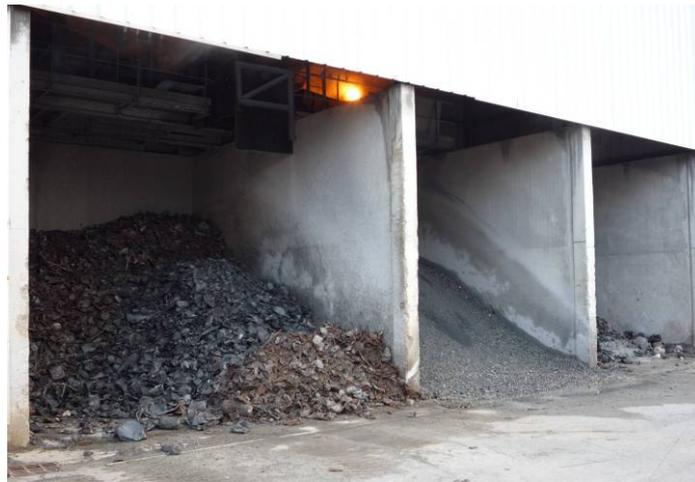
Les ferrailles extraites des mâchefers sont dirigées en filière industrielle de recyclage. Les ferrailles sont évacuées par camion vers un centre de valorisation et les encombrants (refus mâchefers) sont éliminés en Installation de Stockage de Déchets Non Dangereux (ISDND).
