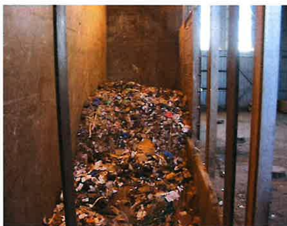
Fosse de réception des Ordures Ménagères
