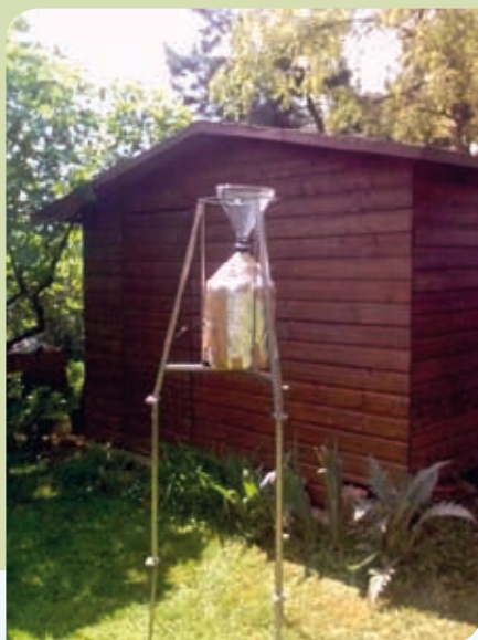
Jauge OWEN utilisée pour la récupération des dioxines, furannes et métaux lourds dans les retombées atmosphériques
