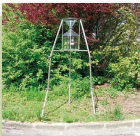
Jauge OWEN utilisée pour la récupération des dioxines, furannes et métaux lourds dans les retombées atmosphériques
